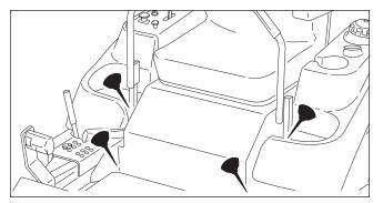
Figure 20. Control Handle Pivots & Seat Plate Pivots
